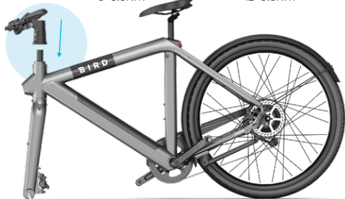
Couple cible 5 \pm 0.5 \text{ Nm}
