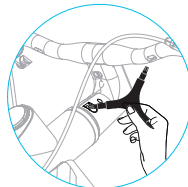
Ziel-Drehmoment 12 \pm 0.5 \text{ Nm}
