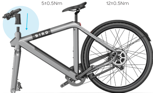
Ziel-Drehmoment 5 \pm 0.5 \text{ Nm}
