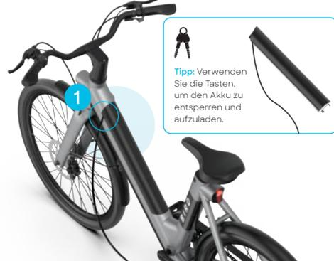
**Tipp:** Verwenden Sie die Tasten, um den Akku zu entsperren und aufzuladen.
